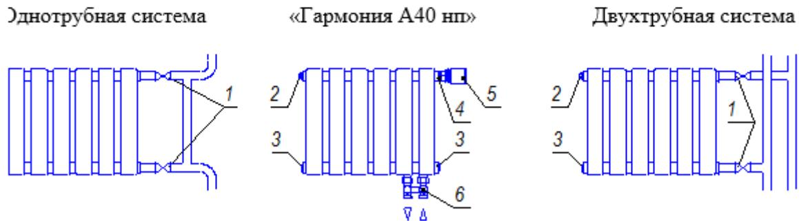
Вентиль. 2. Кран-воздухоотводчик. 3. Пробка глухая. 4. Клапан терморегулятора. 5. Термостатический элемент. 6. Запорно-присоединительный клапан.
