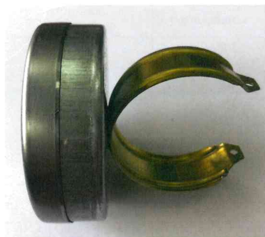
Термометр ТБП-63 без термобаллона (контактное исполнение)
