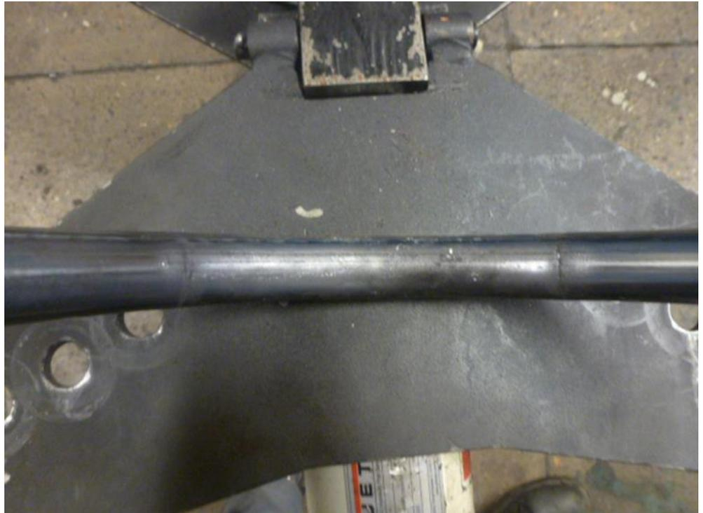
Загнутая труба не имеет трещин и разрывов шва, трещин и разрывов основного металла, что полностью соответствует требованиям ГОСТ 3728. Загнутая труба не имеет гофр, овализации и соответствует требованиям СНиП.
