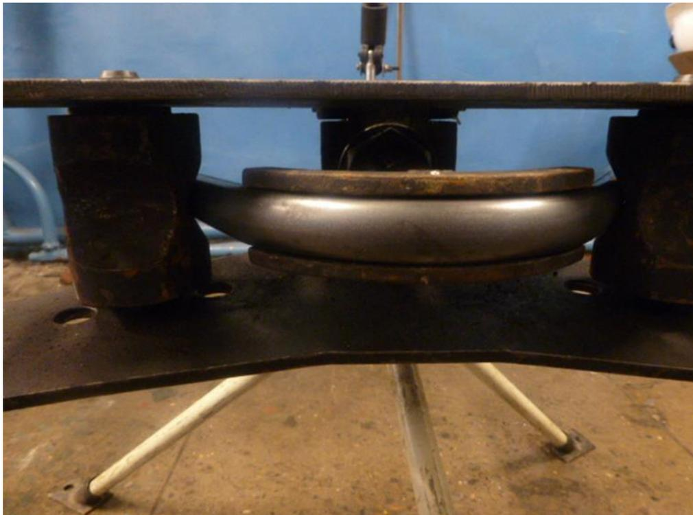
Труба согнута под углом более  $90^\circ$ , для компенсации распружинивания после снятия нагрузки. Труба равномерно заполняет ручей загибочного сектора.
