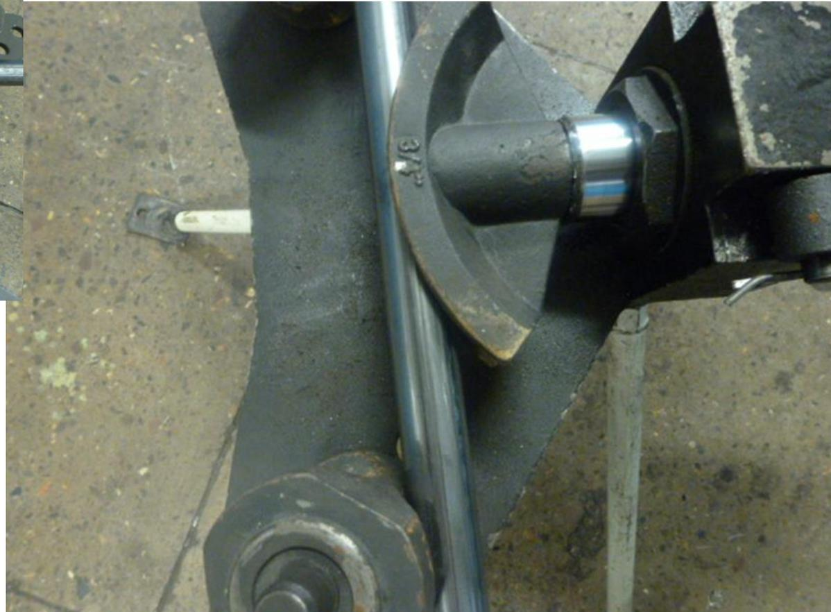
Труба устанавливается в соответствии с ГОСТ 3728. Сварной шов в зоне сжатия под углом  $45^\circ$  к плоскости загиба. Используется стандартный сектор 3/4 дюйма, упорные ролики устанавливаются в соответствующие отверстия станины.
