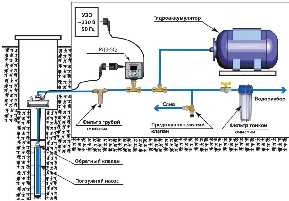
■ 18. Электрическая схема подключения насоса к реле давления серии РДЭ-SQ
