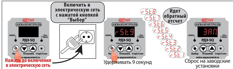
**При сбросе на заводские настройки все параметры реле будут приведены к заводским настройкам в соответствии с таблицами 2 – 4, стр. 6 – 7.**
