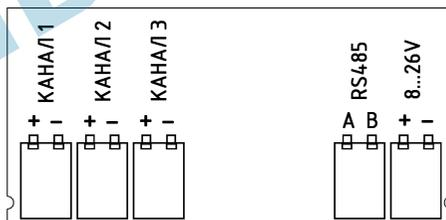
Подключаемые преобразователи с активной выходной цепью (энергия в цепь поступает со стороны преобразователя) должны иметь высокий уровень напряжения от 1,5 до 3В и низкий уровень не более 0,6В. При использовании преобразователей с большим уровнем сигнала рекомендуется использовать пассивный делитель напряжения. Потенциальный провод активной выходной цепи должен быть подключен к контактам «+» клеммников каналов, общий провод к контактам «-» клеммников каналов.
