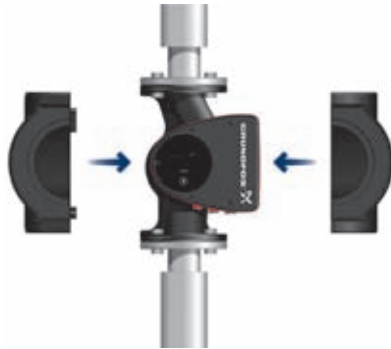
Рис. 24 Установка теплоизоляционного кожуха на насос MAGNA1
