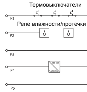
Рис. 26 Исполнение с датчиками №2 (термовыключатели), взрывозащищенное исполнение с датчиками 1
