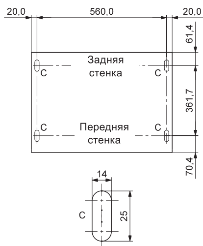
Рис. 56 Шаблон для сверления под подставку (мм)
