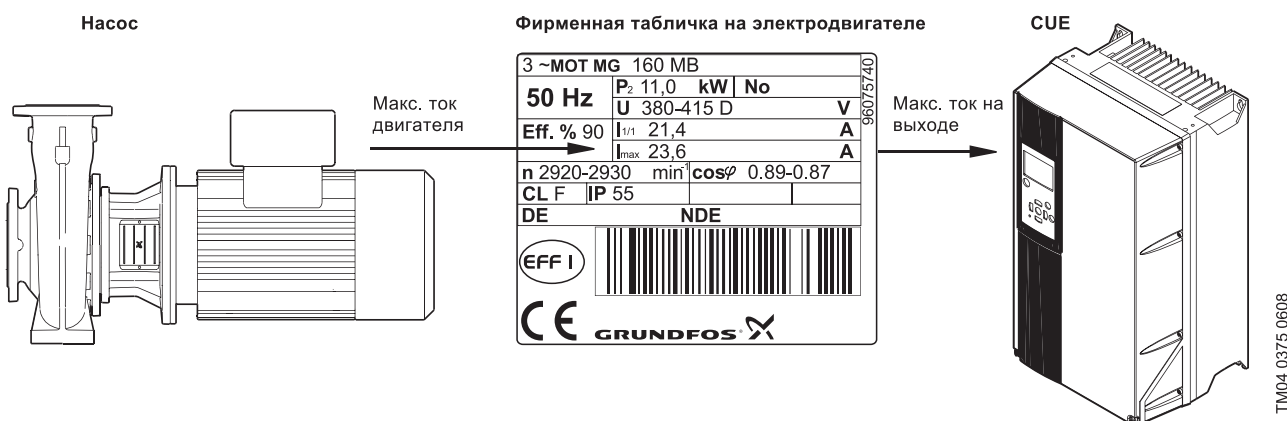
Рис. 45 Подбор CUE на основании максимального тока двигателя.
