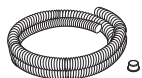
Монтажная трубка – гофрированная пластмассовая трубка предназначена для установки датчика температуры пола и выполняет для него защитную функцию. Диаметр трубки – 16 мм. В комплекте с монтажной трубкой поставляется концевая заглушка.
